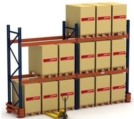
Расми 20. Стеллажҳо ба афзункунии зичии нигоҳдорӣ дар анбор имкон медиҳанд
